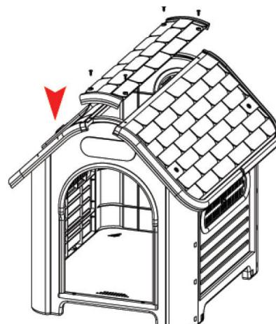
5. Placera taknocken på taket och skruva fast den med 4 skruvar..
