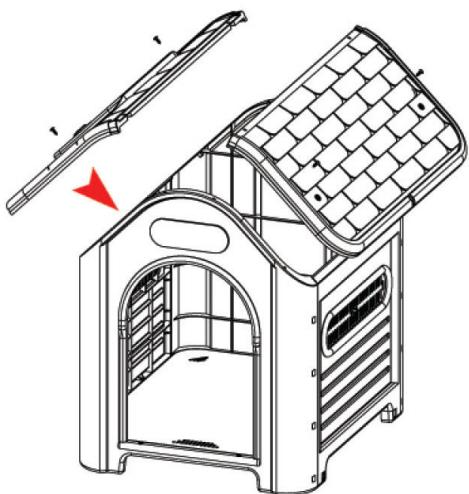
4. Montera fast de undre takdelarna genom att passa in fram- och bakväggarna i skårorna på takpanelen. Skruva fast taket med 2 skruvar per takpanel.
